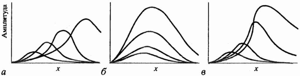
Рис. 2. Развитие локализованного возмущения в системе с постоянным (а, б) и с монотонно замедляющимся (в) потоком: а - конвективная неустойчивость, б - абсолютная неустойчивость, в - остановка волнового фронта
